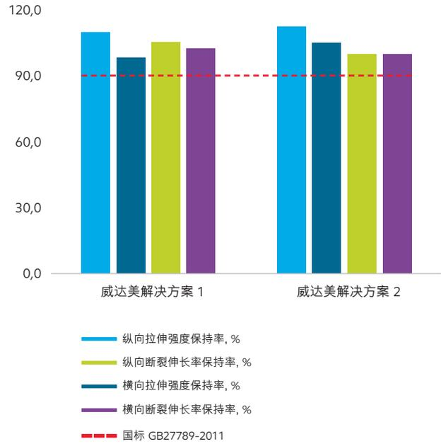
威达美解决方案通过了 8000h 人工气候加速老化测试，并体现出优异的抗热老化性能，符合国标 GB27789-2011。其可靠的性能保证 TPO 屋面长久使用年限。
