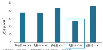
上图显示测试试样使用 A1 表面模具抛光成型时混料的光泽度水平。测试对象为内饰应用中典型的填充 15% 滑石粉的混料:ExxonMobil™ PP7555KNE2 (75%) + 埃佳特™ (10%) + 滑石粉 (15%) 埃克森美孚测试方法
