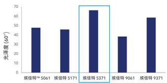
上图显示测试试样使用 A1 表面模具抛光成型时混料的光泽度水平。 测试对象为外饰应用中典型的填充 20% 滑石粉的混料: 埃启峰™ 高阶聚丙烯 PP7945E1 (50%) + ExxonMobil™ PP7032E3 (10%) + 埃佳特™ (20%) + 滑石粉 (20%) 埃克森美孚测试方法
