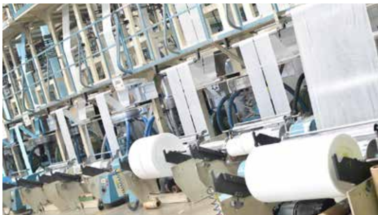
Ternova 一家工厂正在生产 PCR 含量 25% 的集束包装收缩膜。
