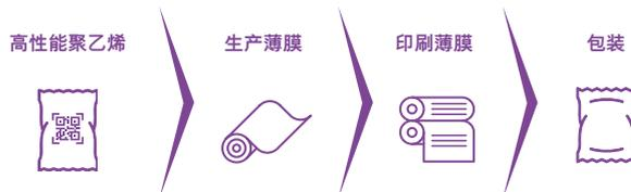
在生产含 66% 认证循环聚乙烯的全聚乙烯冷冻袋的整个价值链中，无缝证明的起点是简单扫描原生树脂袋上的二维码。在原生材料袋上，通过应用包含所有相关信息的二维码，消除了耗时的手动数据输入需求。在 <reifenhauser 莱芬豪舍 > 上生产的薄膜会标有孪生标签，用于在 Comexi 印刷薄膜时确保顺利传递数据。数字产品护照可确保在价值链合作伙伴之间顺利传递数据，保证整个生产链的合规性认证。从源头到成品以及以后的环节，可以交换产品信息，从而为循环经济路径提供支持。
